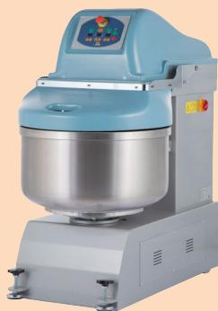
4 x 6.5 kw Çift Devirli Motor, 200 lt. 80 kg Un, 130 kg Hamur %55 ve üstü su oranı için dijital panel ve ısı göstergeli
