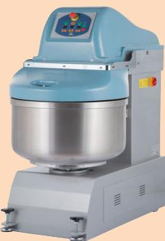
3 x 5.5 kw Çift Devirli Motor, 156 lt. 62.5 kg Un, 100 kg Hamur %55 ve üstü su oranı için dijital panel ve ısı göstergeli
