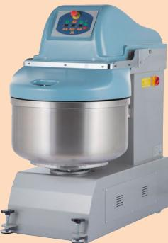
1.5 x 2.5 kw Çift Devirli Motor, 63 lt. 25 kg Un, 40 kg Hamur %55 ve üstü su oranı için dijital panel
